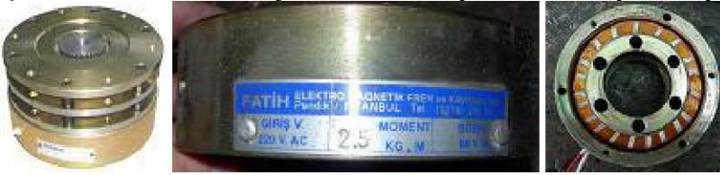
Resim 4.2: Yay baskılı elektromanyetik fren resimleri ve fren bobini
